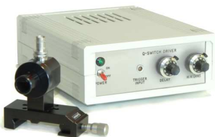
Génération d'impulsion courte par modulateur électro-optique
